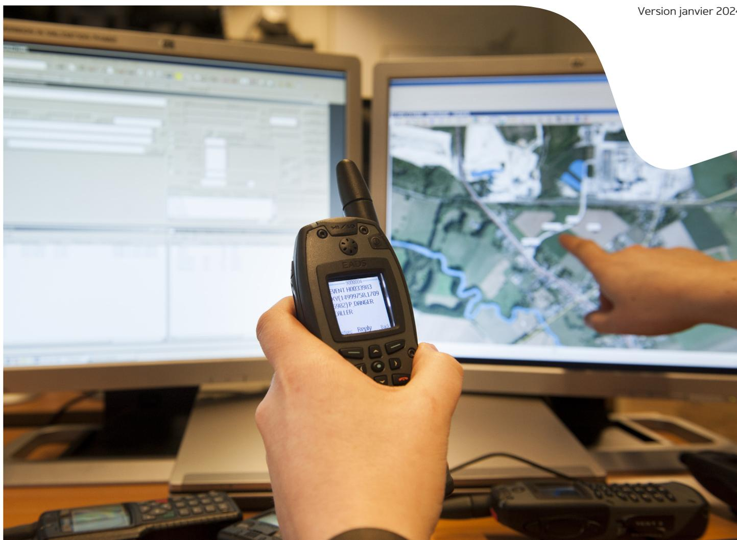
Les solutions de dispatching à distance – également appelées line connected terminals ou LCT – sont des stations de travail installées localement mais reliées aux dispatchings provinciaux (CAD – centrale 100, 101 et 112). Elles offrent une série de fonctionnalités comparables aux stations de travail installées au sein des centres de dispatching provinciaux.
