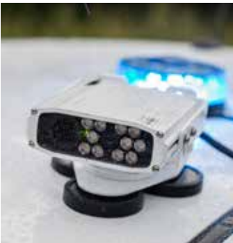
Een controleactie wordt telkens uitgevoerd met twee wagens. De eerste heeft een scanner aan boord die de nummerplaten van de voorbijrijdende voertuigen fotografeert.
