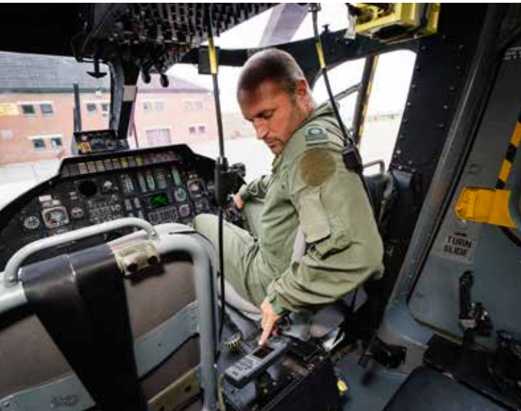
Bij elke vlucht wordt de ASTRID-radio in een ruimte aan de achterkant van de helikopter geschoven, in een speciale container voor luchtvaartuigen. Het display van de ASTRID-radio bevindt zich tussen de twee stoelen vooraan.
